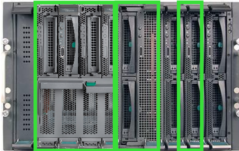
Server-Blade mit zwei CPU
